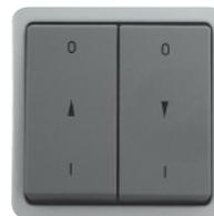
Jalousieschalter/-taster 10 A, 250 V~, (Wippen-Ausführung), **Taster** für Doppelwippe, 1-polig, mit PE-Klemme, mit elektrischer Verriegelung, Kontaktunterbrechung beim Betätigen beider Wippen
