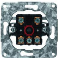
Jalousieschalter / -taster 10 A, 250 V~, **1-polig**, Schloss-Ausführung, wahlweise beidseitige Tast- oder Tast-/Rast-Funktion mit PE-Klemme als Tast-/Rast-Version vormontiert
