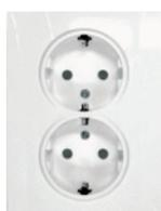
Schuko-Steckdose 2-fach für 55er Einbaudose, volle Platte, mit Schraubklemmen, 2-polig, 10 A, 250 V~, DIN 49440
