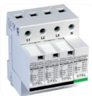
Kombi-Ableiter 4-polig (3+1), 4-TE, **Typ 1+2+3** (Klasse B,C,D), für TN-/ TT-Netze, **für Hutschienenmontage**, Betriebs- und Leckstromfrei daher geeignet für die Montage **im Vorzählerbereich** (VG-Technologie), Varistor + gasgefüllte Funken- und Summenfunkenstrecke.
