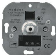
Drehdimmer mit Druck-Wechselschalter, Phasenschnitt, Leistung 75-800W/VA, 230V~, 50Hz, geeignet für Glühlampen/Hochvolt-Halogenlampen
