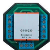
Gruppensteuerrelais, Zentral- und Einzelbedienung, kombinierbar mit allen Systemsteuerungen, Unterputz-Variante geeignet zur Montage in tiefe Schalterdose
