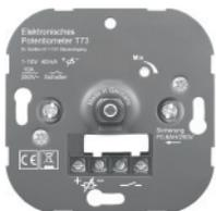
Potentiometer 1-10 V mit Schaltfunktion, Schaltkontakt max. 10A, max. Steuerstrom 40mA (Herstellerangaben der angeschlossenen Geräte berücksichtigen), zum Dimmen von EVG's oder anderen Geräten mit 1-10 Volt Steuereingang
