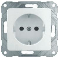
Schuko-Steckdose Kombi, mit schraubenloser Steckklemme, 2-polig + PE, 10/16 A, 250V~, DIN 49440, Verbindungsklemmen gemäß VDE 0620
