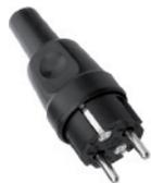
Vollgummi-Stecker mit Schutzkontakt, **schwere Industrierausführung, mit Schnappverrastung**, zentrale Leitungseinführung mit Knickschutz, geeignet für Kabel bis H07RN-F 3 x 2,5 mm<sup>2</sup>, IP44, 2-polig + PE, 16A, 250V~
