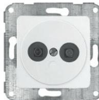
Potentialausgleich-Dose passend in 58er Dose mit Schraubbefestigung. 1-fach, mit Abdeckung, zum Anschluss ortsveränderlicher, medizinischer Geräte Anschlussleitungen bis 1x6 mm<sup>2</sup> und 4x2,5 mm<sup>2</sup> nach DIN 57197 und VDE 0107 Stecker: Potentialleiter-Winkelstecker nach DIN 42801, bis 6 mm<sup>2</sup>
