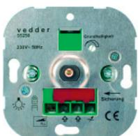
Drehdimmer mit Druck-Wechselschalter, Phasen**an**schnitt, Leistung 20-250W/VA, LED-Leistung 3-85W, 230V~, 50Hz, geeignet für **dimmbare LED-Lampen**, Glühlampen/ HVHalogenlampen, NV-Halogenlampe mit gewickelten Trafos
