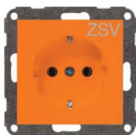
Schuko-Steckdose ZSV (zusätzliche Sicherheitsversorgung) mit schraubenloser Steckklemme, 2-polig + PE, 10/16 A, 250 V~, DIN 49440, Verbindungsklemmen gemäß VDE 0620
