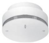
**Rauchwarnmelder, nach EN 14604** - Rauchtest auch nach En54-7, mit **potentialfreiem Wechslerkontakt** zur Ansteuerung des PrestoLift-Systems. Inkl. geprüften Batterien mit mind. Lebensdauer 10 Jahre (unter normalen Temperaturbedingungen 15°C-25°C und regelmäßigem Funktionstest entsprechend DIN 14676) Integrierter Alarmgeber für akustische Alarmierung (>85 dB) und LED-Anzeige für Alarm und Störungsmeldungen. Einfache Stummschalt- und Testfunktionsmöglichkeit.
