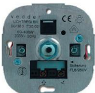
Drehdimmer mit Dreh-Aus-Funktion, Phasenschnitt, Leistung 60-400W/VA, 230V~, 50Hz, geeignet für Glühlampen/Hochvolt-Halogenlampen
