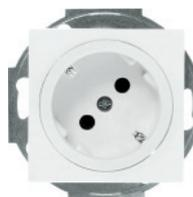
Schuko-Steckdose 45° gedrehte Einführung, mit schraubenloser Steckklemme, 2-polig + PE, 10/16 A, 250 V~, DIN 49440, Verbindungsklemmen gemäß VDE 0620
