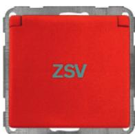
Schuko-Steckdose ZSV mit Klappdeckel, 2-polig + PE, mit schraubenloser Steckklemme, 10/16 A, 250 V~, DIN 49440, Verbindungsklemmen gemäß VDE 0620.
