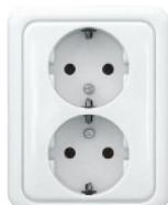
Schuko-Steckdose 2-fach für 55er Einbaudose, volle Platte, mit Schraubklemmen, 2-polig + PE, 10 A, 250 V~, DIN 49440
