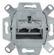
UAE-CAT6A-Anschlussdose, 2x Steckbuchse 8-polig, erfüllt die Anforderungen **für 500 MHz Bandbreite (10Gbit/s)** nach ISO/IEC11801/DIN EN 60603-7-51, anpassbarer Tragring für Montage in UP-Dosen, Kabelkanälen und UF-Geräteinsätzen
