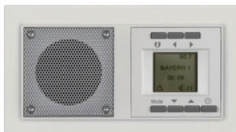
**DELTA miro Unterputz-Radio, inkl. Rahmen** mit Lautsprecherabdeckung. Durch das drehbare Bedienteil ist eine senkrechte oder waagerechte Montage in einer 2-fach-Geräte- oder Geräte-Doppeldose UP/HW (Kombinationslochanstand 71 mm) möglich.
