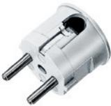
Universal-Stecker mit Schutzkontakt, Duroplast, seitliche Leitungseinführung, 2-polig + PE, 16A, 250V~
