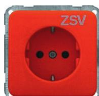
Schuko-Steckdose ZSV mit schraubenloser Steckklemme, 2-polig + PE, 10/16 A, 250 V~, DIN 49440, orange, Verbindungsklemmen gemäß VDE 0620
