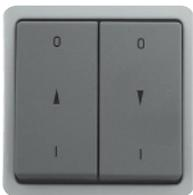
Jalousieschalter/-taster 10 A, 250 V~, (Wippen-Ausführung), **Schalter** für Doppelwippe, 1-polig, mit PE-Klemme, mit elektrischer Verriegelung, Kontaktunterbrechung beim Betätigen beider Wippen
