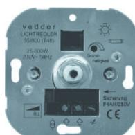
Drehdimmer mit Druck-Wechselschalter, Phasenanschnitt, für Leuchtstofflampen mit 38mm Durchmesser mit Heiztrafo und Schirmgitter, Leistung: 25-800W/VA, 230V~, 50Hz, Grundlast mind. 25W (Ohmsche Last)
