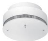
**Rauchwarnmelder, nach EN 14604** - Rauchtest auch nach EN54-7, mit **potentialfreiem Wechslerkontakt** zur Ansteuerung des PrestoLift-Systems. Inkl. geprüften Batterien mit mind. Lebensdauer 10 Jahre (unter normalen Temperaturbedingungen 15°C-25°C und regelmäßigem Funktionstest entsprechend DIN 14676) Integrierter Alarmgeber für akustische Alarmierung (>85 dB) und LED-Anzeige für Alarm und Störungsmeldungen. Einfache Stummschalt- und Testfunktionsmöglichkeit.
