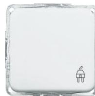
Schuko-Steckdose mit Klappdeckel, mit schraubloser Steckklemme, 2-polig + PE, 10/16 A, 250 V~, DIN 49440, Verbindungsklemmen gemäß VDE 0620
