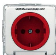
Schuko-Steckdose, Überspannungsschutzsteckdose, mit Beschriftungsfeld und Papierstreifen, 2-polig + PE, 10/16 A, 250 V~, DIN 49440, Verbindungsklemmen gemäß VDE 0620
