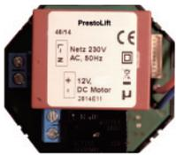
**Zentrales Steuermodul** zur Ansteuerung eines Gleichstrom-Rollladenantriebes bei Netzausfall, **inkl. Akku und Anschlusszubehör**. Einzel-, Gruppenbedienung möglich, sowie Anschluss potentialfreier Steuerungssysteme (GLT, Rauchmelder...).
