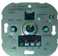
Drehdimmer mit Druck-Wechselschalter, Phasenschnitt, Leistung 60-600W/VA, 230V~, 50Hz, geeignet für Glühlampen/ Hochvolt-Halogenlampen
