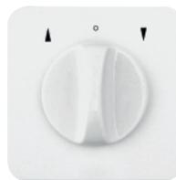
Jalousieschalter/-taster Unterputz, in Schaltknebel-Ausführung, 10 A, 250 V~, 1-polig, mit N- und PE-Klemme als „volle Platte“, Komplettartikel, als Tast-/ Rast-Funktion vormontiert, weiß
