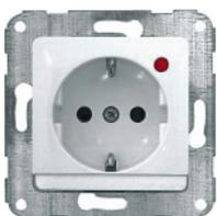
Schuko-Steckdose mit Glühlampe, Spannungsanzeige durch Kontroll-Licht, mit Schraubklemmen, 2-polig + PE, 10/16 A, 250V~, DIN 49440, Verbindungsklemmen gemäß VDE 0620
