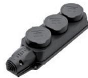
Steckdosenleiste 3-fach mit Schutzkontakt und Deckel, thermoplastisches Elastomer TPE (gummiähnlich), für erschwerte Bedingungen, **mit Schnappverrastung**, Aufhängeöse und 4 Befestigungspunkten, geeignet für Kabel bis H07RN-F 3 x 2,5 mm<sup>2</sup>, IP44, 16A, 250V~, 2-polig + PE
