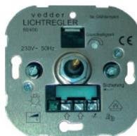
Drehdimmer mit Druck-Wechselschalter, Phasenschnitt, Leistung 60-400W/VA, 230V~, 50Hz, geeignet für Glühlampen/Hochvolt-Halogenlampen
