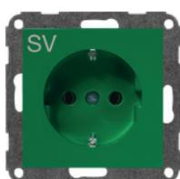
Schuko-Steckdose SV (Sicherheitsversorgung), mit schraubenloser Steckklemme, 2-polig + PE, 10/16 A, 250 V~, DIN 49440, Verbindungsklemmen gemäß VDE 0620
