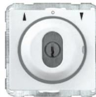
Jalousieschalter/-taster 10 A, 250 V~, mit Schloss wahlweise beidseitige Tast- oder Tast-/Rast-Funktion, **2-polig**, für 2 Motoren, als Tast-/Rast-Version vormontiert, Schlüssel mittig abziehbar, (Sicherheitsschloss-Ausführung)
