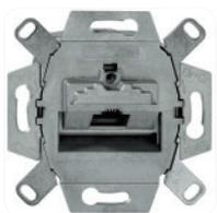
UAE-CATEA-Anschlussdose, 1x Steckbuchse 8-polig, erfüllt die Anforderungen **für mind. 250 MHz Bandbreite (1Gbit/s)** nach ISO/IEC11801/DIN EN 60603-7-51, anpassbarer Tragring für Montage in UP-Dosen, Kabelkanälen und UF-Geräteinsätzen
