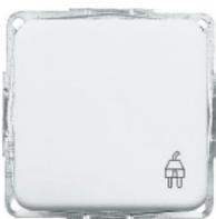
Schuko-Steckdose **mit Kinderschutz** und Klappdeckel, mit schraubloser Steckklemme, 2-polig + PE, 10/16 A, 250 V~, DIN 49440, Verbindungsklemmen gemäß VDE 0620
