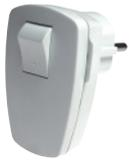
Schutzkontakt-Winkelstecker, Thermoplast, **mit Schalter - ohne Beleuchtung**, max. Leitungsquerschnitt 1,5 mm<sup>2</sup>, IP20, 2-polig + PE, 16A, 230V~
