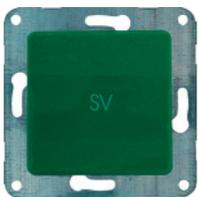
Schuko-Steckdose ZSV mit Klappdeckel, mit schraubenloser Steckklemme, 2-polig + PE, 10/16 A, 250 V~, DIN 49440, grün, Verbindungsklemmen gemäß VDE 0620
