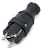
Stecker mit Schutzkontakt, thermoplastisches Elastomer TPE (gummiähnlich), für erschwerte Bedingungen, **mit Schnappverrastung**, geeignet für Kabel bis H07RN-F 3 G2,5 mm<sup>2</sup>, IP44, 2-polig + PE, 16A, 250V~
