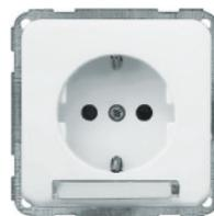
Schuko-Steckdose mit Beschriftungsfeld und Papierstreifen, mit schraubloser Steckklemme, 2-polig + PE, 10/16 A, 250 V~, DIN 49440, Verbindungsklemmen gemäß VDE 0620
