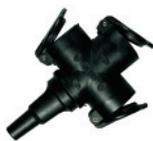
3-Wege-Vollgummi-Kupplung, **schwere Industrierausführung, mit Schnappverrastung**, zentrale Kabeleinführung mit Knickschutz, mit Aufhängebügel und Deckel, geeignet für Kabel bis H07RN-F 3 x 2,5 mm<sup>2</sup>, IP44, 2-polig + PE, 16A, 250V~
