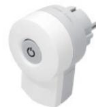
Winkelstecker, Thermoplast, **mit LED-Kontrollschalter - rastend**, seitliche Leitungsausführung, mit 2 Schutzkontaktsystemen, geeignet für Leitungsquerschnitte bis 1,5mm<sup>2</sup>, IP20, 2-polig + PE, 16A, 250V~
