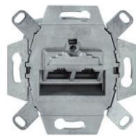
UAE-CATEA-Anschlussdose, 2x Steckbuchse 8-polig, erfüllt die Anforderungen **für mind. 250 MHz Bandbreite (1Gbit/s)** nach ISO/IEC11801/DIN EN 60603-7-51, anpassbarer Tragring für Montage in UP-Dosen, Kabelkanälen und UF-Geräteinsätzen
