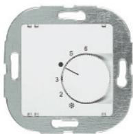
Raumthermostat (elektromechanisch) 250 V~, 50/60 Hz 10 (4) A, **Wechsler** (Umschalter), Absenkung
