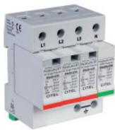
Überspannungsschutz 4-polig (3+1), 4-TE, **Typ 2** (Klasse B), für TN-/ TT-Netze, geeignet für die **Hutschienenmontage im Nachzählerbereich und in Unterverteilungen**.
