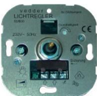
Drehdimmer mit Druck-Wechselschalter, Phasenschnitt, Leistung 60-600W/VA, 230V~, 50Hz, geeignet für Glühlampen/ Hochvolt-Halogenlampen
