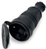
Kupplung mit Schutzkontakt, thermoplastisches Elastomer TPE (gummiähnlich), für erschwerte Bedingungen, **mit Schnappverrastung und Deckel**, mit Deckel und im gesteckten Zustand wird Spritzwasserschutz erreicht, geeignet für Kabel bis H07RN-F 3 x 2,5 mm<sup>2</sup>, IP44, 2-polig + PE, 16A, 250V~
