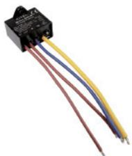
Kompakter Überspannungsschutzbaustein 1-polig, **Typ 2+3** (Klasse C,D), mit festverdrahteten Anschlussleitungen. Geeignet für die ortsnahe Montage an zu schützenden Endgeräten z.B. für LED Außenbeleuchtungen. Ableiter mit **Varistor-Technologie** und Summenfunkenstrecke. **Optische defekt Anzeige** mit **gleichzeitiger Netztrennung des zu schützenden Endgerätes.**
