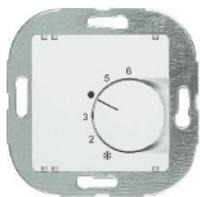
Raumtemperaturregler, Bimetall, inkl. Abdeckung, **ohne Absenkung, Öffner**, 50mmx50mm, Unterputz
