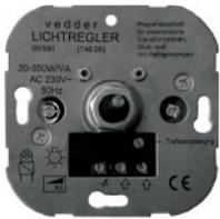
Drehdimmer mit Druck-Wechselschalter, Phasen**ab**schnitt, Leistung 20-500W/VA, 230V~, 50Hz, geeignet für Niedervolt-Halogenlampen mit elektronischen Trafos, Glühlampen/ Hochvolt-Halogenlampen
