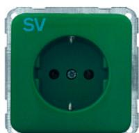
Schuko-Steckdose SV (Sicherheitsversorgung), mit schraubenloser Steckklemme, 2-polig + PE, 10/16 A, 250 V~, DIN 49440, grün, Verbindungsklemmen gemäß VDE 0620
