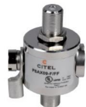
Koaxialer Überspannungsschutz mit **F-Anschluss**, in **wasserdichtem** Gehäuse für HF-Anwendungen wie Sat-oder BK-Anlagen, niedrige Signalverluste, DC-Übertragung möglich.
