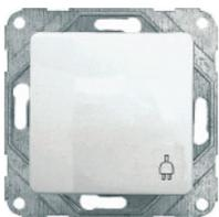
Schuko-Steckdose mit Klappdeckel, mit schraubenloser Steckklemme, 2-polig + PE, 10/16 A, 250V~, DIN 49440, Verbindungsklemmen gemäß VDE 0620
