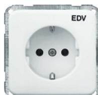
Schuko-Steckdose mit EDV-Aufdruck, mit schraubenloser Steckklemme, 2-polig + PE, 10/16 A, 250 V~, DIN 49440, Verbindungsklemmen gemäß VDE 0620
