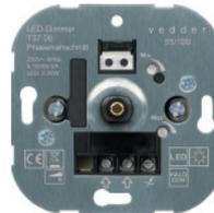
Drehdimmer mit Druck-Wechselschalter, Phasen**an**schnitt, Leistung 5-100W/VA, LED-Leistung 3-35W, 230V~, 50Hz, geeignet für **dimmbare LED-Lampen**, **dimmbare LED-Treiber**, Glühlampen/HV-Halogenlampen
