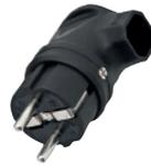
Winkelstecker mit Schutzkontakt, thermoplastisches Elastomer TPE (gummiähnlich), für erschwerte Bedingungen, **mit Schnappverrastung**, geeignet für Kabel bis H07RN-F 3 G2,5 mm<sup>2</sup>, IP44, 2-polig + PE, 16A, 250V~
