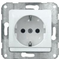
Schuko-Steckdose mit Beschriftungsfeld und Papierstreifen, mit schraubenloser Steckklemme, 2-polig + PE, 10/16 A, 250V~, DIN 49440, Verbindungsklemmen gemäß VDE 0620
