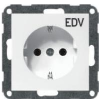
Schuko-Steckdose mit EDV-Aufdruck, mit schraubenloser Steckklemme, 2-polig + PE, 10/16 A, 250 V~, DIN 49440, Verbindungsklemmen gemäß VDE 0620
