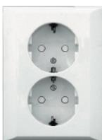
Schuko-Steckdose 2-fach für 55er Einbaudose, volle Platte, mit Schraubklemmen, **mit Kinderschutz**, 2-polig + PE, 10 A, 250 V~, DIN 49440
