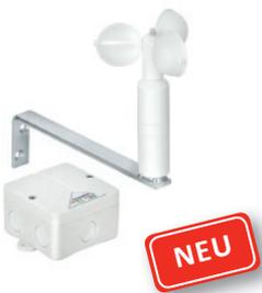
PrestoWind Windwächter, inkl. Montagematerial, Netzspannung 230 V~, 50 Hz, 0,5 W, Schaltstrom 4 A, Schutzart: IP65, Schutzklasse: II, Windeinstellbereich: bis 15 m/Sek. (55 km/Std.), Windreaktionszeit: max 5 Sek., Windblockierzeit: 10 Min. fest
