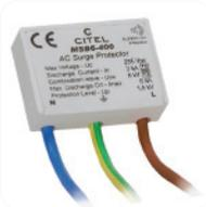
Kompakter Überspannungsschutzbaustein 1-polig, **Typ 3** (Klasse C), mit festverdrahteten Anschlussleitungen. Geeignet für die **ortsnahe Montage** an zu **schützenden Endgeräten** z.B. in Schalterdosen oder Abzweigdosen. Ableiter mit **Varistor-Technologie** und Summenfunkenstrecke. **Akustische defekt Anzeige** mit gleichzeitiger Trennung des Ableiters vom Netz – **Endgerät bleibt weiter in Funktion!** Erfüllt die Normen IEC 61643-11 und EN 61643-11
