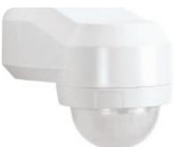
**Infrarot-Aufputz Bewegungsmelder**, ultraweiß, IP55, geeignet für die **Wand-, Decken- und Eckmontage** (Adapter für Innen- und Außenecken). Wärmeausgleichsfunktion zur Anpassung der Sensibilität, bei sich verändernden Außentemperatur. **Relaisansteuerung mit Nulldurchgang-Schaltung**. Mit optionalem Schalter kann zwischen Automatik- und Manuell-Betrieb umgeschaltet werden.
