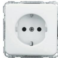
Schuko-Steckdose, Kombi mit schraubloser Steckklemme, 2-polig + PE, 10/16 A, 250 V~, DIN 49440, Verbindungsklemmen gemäß VDE 0620
