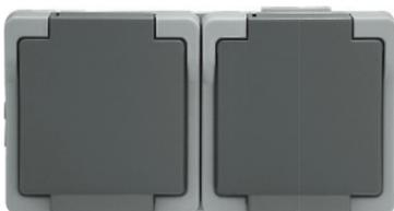
2-fach Schuko-Steckdose, 16 A, 250 V~, DIN 49440, waagrecht, mit Klappdeckel, 2-polig + PE, vorverdrahtet, schraubenlose Steckklemme, aus bruchsicherem Thermoplast, Federn rostfrei, Verbindungsklemmen gemäß VDE
