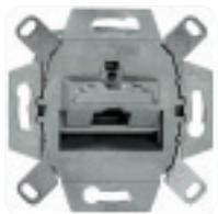
UAE-CAT6A-Anschlussdose, 1x Steckbuchse 8-polig, erfüllt die Anforderungen **für 500 MHz Bandbreite (10Gbit/s)** nach ISO/IEC11801/DIN EN 60603-7-51, anpassbarer Tragring für Montage in UP-Dosen, Kabelkanälen und UF-Geräteinsätzen
