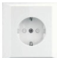
Schuko-Steckdose volle Platte, **mit Kinderschutz** und schraubenloser Steckklemme, 2-polig + PE, 10/16 A, 250 V~, DIN 49440, Verbindungsklemmen gemäß VDE 0620
