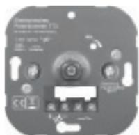
Potentiometer 1-10 V mit Schaltfunktion, Schaltkontakt max. 10A, max. Steuerstrom 40mA (Herstellerangaben der angeschlossenen Geräte berücksichtigen), zum Dimmen von EVG's oder anderen Geräten mit 1-10 Volt Steuereingang
