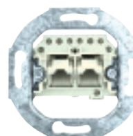
UAE-Anschlussdose CAT 3, 2x parallel geschaltete Steckbuchsen, 2 x 8 (8)-polig Universalanschluß-Einheit RJ 11 / 12, RJ 45 nach Kategorie 3, ISDN-fähig, für den Einbau in Unterputzdosen. Mit Schrägauslass sowie Schraubkontakten, nach IEC 603-7, DIN EN 60 603-7
