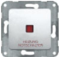
Heizung Notschalter mit Wippe **1-polig**, mit Glühlampe 8302 und Beschriftung, Kontroll-Ausschalter 10 A / 250 V~
