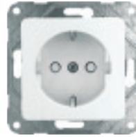
Schuko-Steckdose **mit Kinderschutz** mechanisch verriegelt, mit schraubenloser Steckklemme, 2-polig + PE, 10/16 A, 250 V~, DIN 49440, Verbindungsklemmen gemäß VDE 0620
