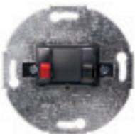
Lautsprecherdose 1-fach, AC 25 V DC 60 V, schwarz, mit Kabelquerschnitt bis zu 4 mm<sup>2</sup> vorne und bis zu 6 mm<sup>2</sup> hinten, geeignet für einen Lautsprecher
