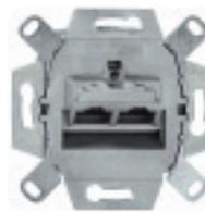
UAE-CAT6A-Anschlussdose, 2x Steckbuchse 8-polig, erfüllt die Anforderungen **für 500 MHz Bandbreite (10Gbit/s)** nach ISO/IEC11801/DIN EN 60603-7-51, anpassbarer Tragring für Montage in UP-Dosen, Kabelkanälen und UF-Geräteinsätzen
