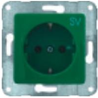
Schuko-Steckdose SV (Sicherheitsversorgung), mit schraubenloser Steckklemme, 2-polig + PE, 10/16 A, 250 V~, DIN 49440, grün, Verbindungsklemmen gemäß VDE 0620
