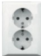
Schuko-Steckdose 2-fach für 55er Einbaudose, volle Platte, mit Schraubklemmen, 2-polig + PE, 10 A, 250 V~, DIN 49440
