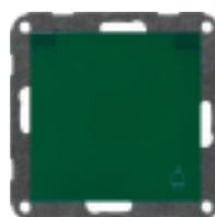
Schuko-Steckdose SV (Sicherheitsversorgung) mit Klappdeckel, mit schraubenloser Steckklemme, 2-polig + PE, 10/16 A, 250 V~, DIN 49440, Verbindungsklemmen gemäß VDE 0620
