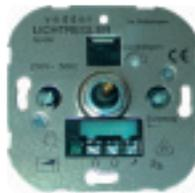
Drehdimmer mit Druck-Wechselschalter, Phasenanschnitt, Leistung 60-400W/VA, 230V~, 50Hz, geeignet für Glühlampen/Hochvolt-Halogenlampen
