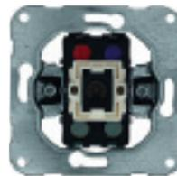
Taster Wechsler, 10 A, 250 V~, 1-polig, verwendbar als Öffner (Ruhestrom) oder als Schließer (Arbeitsstrom), mit E-10 Gewinde, ohne Glühlampe, mit schraublosem Steckanschluss
