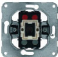
Ausschalter 10 A, 250 V~, 2-polig, mit schraublosem Steckanschluss, für Schalterwippe 7002W / UW, 2002UW, 3002W / UW
