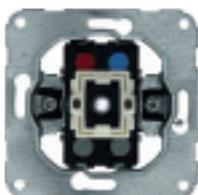
Kontroll-Aus-/Wechschler, 10 A, 250 V~, mit Glimmlampe Nr. 8302, mit schraublosem Steckanschluss
