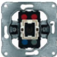
Taster Schliesser, 10 A, 250 V~, mit getrennter Beleuchtung, mit E-10 Gewinde, ohne Glühlampe, mit schraublosem Steckanschluss
