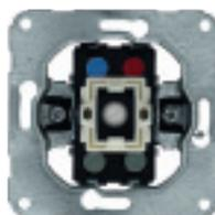
Kontroll-Ausschalter, 2-polig 10 A, 250 V~, mit Glimmlampe Nr. 8302, mit schraublosem Steckanschluss, für Wippe 7002KW / UW, 2002KUW, 3002KW / UW
