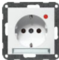
Schuko-Steckdose mit Glühlampe, Beschriftungsfeld und Papierstreifen, Spannungsanzeige durch Kontroll-Licht, mit Schraubklemmen, 2-polig + PE, 10/16 A, 250 V~, DIN 49440, Verbindungsklemmen gemäß VDE 0620
