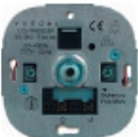
Drehdimmer mit Dreh-Aus-Funktion, Phasenanschnitt, Leistung 60-400W/VA, 230V~, 50Hz, geeignet für Glühlampen/Hochvolt-Halogenlampen
