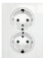
Schuko-Steckdose 2-fach für 55er Einbaudose, volle Platte, mit Schraubklemmen, 2-polig, 10 A, 250 V~, DIN 49440
