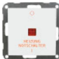
Heizung Notschalter mit Wippe, **2-polig**, mit Glimmlampe 8302 und Beschriftung, Kontroll-Ausschalter 10 AA/250 A/V~
