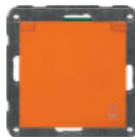
Schuko-Steckdose ZSV (zusätzliche Sicherheitsversorgung) mit Klappdeckel mit schraubenloser Steckklemme, 2-polig + PE, 10/16 A, 250 V~, DIN 49440, Verbindungsklemmen gemäß VDE 0620
