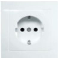
Schuko-Steckdose volle Platte, mit schraubenloser Steckklemme, 2-polig + PE, 10/16 A, 250 V~, DIN 49440, Verbindungsklemmen gemäß VDE 0620
