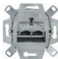
UAE-CATEA-Anschlussdose, 2x Steckbuchse 8-polig, erfüllt die Anforderungen **für mind. 250 MHz Bandbreite (1Gbit/s)** nach ISO/IEC11801/DIN EN 60603-7-51, anpassbarer Tragring für Montage in UP-Dosen, Kabelkanälen und UF-Geräteinsätzen
