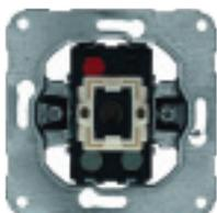
Universalschalter Aus/Wechsel 10 A, 250 V~, mit E-10 Gewinde, mit schraublosem Steckanschluss, durch Einsatz der Glimmlampe Nr. 8302 als beleuchteter Schalter einsetzbar
