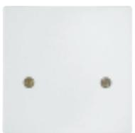
Herdanschlussdose 400 V~, für die Auf- und Unterputz-Montage geeignet, Nennquerschnitt 2,5 mm<sup>2</sup>, 5 Doppelklemmen, großer, übersehbarer Anschlussraum, Schraub- und Krallenbefestigung für 58ziger und 70ziger UP-Dosen, mit abwerfbaren Spreizkrallen
