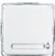
Schuko-Steckdose mit Klappdeckel, Beschriftung und Papierstreifen, mit schraubenloser Steckklemme, 2-polig + PE, 10/16 A, 250 V~, DIN 49440, Verbindungsklemmen gemäß VDE 0620
