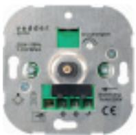
Drehdimmer mit Druck-Wechselschalter, Phasen**an**schnitt, Leistung 7-110W/VA, LED-Leistung 3-35W, 230V~, 50Hz, geeignet für **dimmbare LED-Lampen**, Glüh-/ HV-Halogenlampen und NV-Lampen mit gewickelten Trafos
