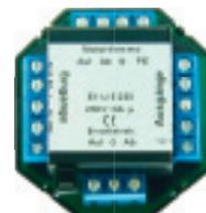
Elektronisches Trennrelais für einen Antrieb, Zentral- und Einzelbedienung, **mit 180 Sekunden Selbsthaltung**
