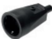
Kupplung mit Schutzkontakt, PVC, mit Knickschutztülle und Querteilung, 2-polig + PE, 16A, 250V~
