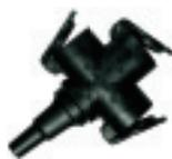
3-Wege-Vollgummi-Kupplung, **schwere Industrieausführung, mit Schnappverrastung**, zentrale Kabeleinführung mit Knickschutz, mit Aufhängebügel und Deckel, geeignet für Kabel bis H07RN-F 3 x 2,5 mm<sup>2</sup>, IP44, 2-polig + PE, 16A, 250V~
