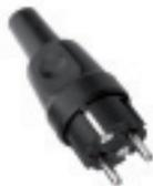
Vollgummi-Stecker mit Schutzkontakt, **schwere Industrieausführung, mit Schnappverrastung**, zentrale Leitungseinführung mit Knickschutz, geeignet für Kabel bis H07RN-F 3 x 2,5 mm<sup>2</sup>, IP44, 2-polig + PE, 16A, 250V~
