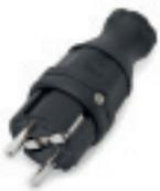
Stecker mit Schutzkontakt, thermoplastisches Elastomer TPE (gummiähnlich), für erschwerte Bedingungen, **mit Schnappverrastung**, geeignet für Kabel bis H07RN-F 3 G2,5 mm<sup>2</sup>, IP44, 2-polig + PE, 16A, 250V~
