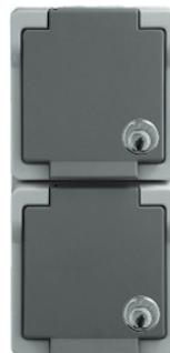
2-fach Schuko-Steckdose, 16 A, 250 V~, DIN 49440, **senkrecht**, mit Klappdeckel, 2-polig + PE, **vorverdrahtet**, schraubenlose Steckklemme, aus bruchsicherem Thermoplast, Federn rostfrei, Verbindungsklemmen gemäß VDE, **abschließbar (1) - 24 verschiedene Schließungen wählbar**
