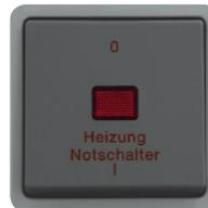
Heizung Notschalter, 2-polig, 10 A, 250 V~, mit Glimmlampe 8302 und Beschriftung, roter Linse, schraubenlosem Steckanschluss
