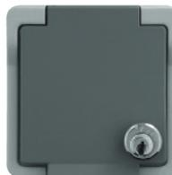
Schuko-Steckdose, 16 A, 250 V~, DIN 49440, mit Klappdeckel, 2-polig + PE, **abschließbar (2)**, **gleichschließend**, schraubenlose Steckklemme, aus bruchsicherem Thermoplast, Federn rostfrei, Verbindungsklemmen gemäß VDE
