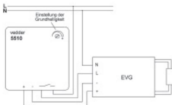
Dieses Potentiometer ist für den Betrieb von elektronischen Vorschalt-Geräten (EVG) mit 10 Volt Steuereingang geeignet und für den Einbau in Unterputz-Einbaudosen vorgesehen.
