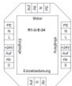
Trennrelais für einen Antrieb, Unterputzmontage, Zentral- und Einzelbedienung, erweiterbar mit weiteren R1UE24/G1U24
