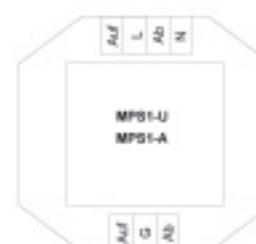
Mehrpunktsteuerrelais für einen Antrieb, **mit 180 Sekunden Selbsthaltung**, kombinierbar mit allen Systemsteuerungen
