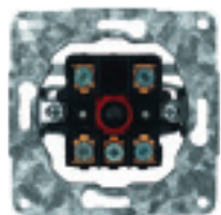
Jalousieschalter / -taster 10 A, 250 V~, 1-polig , Schloss-Ausführung, wahlweise beidseitige Tast- oder Tast-/Rast-Funktion mit PE-Klemme als Tast-/Rast-Version vormontiert
