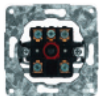
Jalousieschalter / -taster 10 A, 250 V~, 1-polig , Schaltknebel-Ausführung, wahlweise beidseitige Tast- oder Tast-/Rast-Funktion mit PE-Klemme als Tast-/Rast-Version vormontiert
