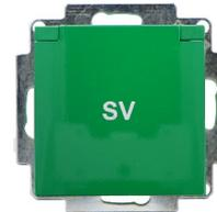
Schuko-Steckdose SV (Sicherheitsversorgung) mit Klappdeckel, mit schraubloser Steckklemme, 2-polig + PE, 16A, 250V ~, DIN 49440, Verbindungsklemmen gemäß VDE 0620
