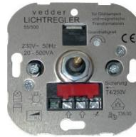
Drehdimmer mit Druck-Wechselschalter, Phasenanschnitt, Leistung: 20-500W / VA, 230V ~, 50Hz, geeignet für Niedervolt-Halogenlampen mit gewickelten Trafos, Glühlampen / Hochvolt-Halogenlampen
