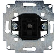
Taster Wechsler, 10A, 250V ~, 1-polig, verwendbar als Öffner (Ruhestrom) oder als Schließer (Arbeitsstrom), Beleuchtungseinsatz nachrüstbar, mit schraublosem Steckanschluss
