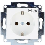
Schuko-Steckdose mit EDV-Aufdruck, mit schraubloser Steckklemme, 2-polig + PE, 16A, 250V ~, DIN 49440, Verbindungsklemmen gemäß VDE 0620
