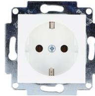
Schuko-Steckdose **mit erhöhtem Berührungsschutz (Shutter)** mit schraubloser Steckklemme, 2-polig + PE, 16A, 250V ~, DIN 49440, Verbindungsklemmen gemäß VDE 0620
