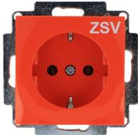
Schuko-Steckdose ZSV (zusätzliche Sicherheitsversorgung) mit schraubloser Steckklemme, 2-polig + PE, 16A, 250V ~, DIN 49440, Verbindungsklemmen gemäß VDE 0620
