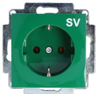
Schuko-Steckdose SV (Sicherheitsversorgung), mit schraubloser Steckklemme, 2-polig + PE, 16A, 250V ~, DIN 49440, Verbindungsklemmen gemäß VDE 0620
