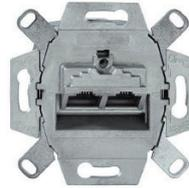
UAE-CAT6A-Anschlussdose, 2x Steckbuchse 8-polig, erfüllt die Anforderungen **für 500 MHz Bandbreite (10Gbit/s)** nach ISO/IEC11801/DIN EN 60603-7-51, anpassbarer Tragrings für Montage in UP-Dosen, Kabelkanälen und UF-Geräteinsätzen
