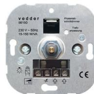
Drehdimmer mit Druck-Wechselschalter, Phasen**ab**schnitt, Leistung: 15-150W / VA, LED-Leistung: 3-50W, 230V ~, 50Hz, geeignet für **dimmbare LED-Lampen**, **dimmbare LED-Treiber**, Glühlampen / HV-Halogenlampen, NV-Halogenlampe mit elektronischen Trafos
