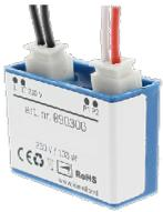
Gerätedosen-Einbaudimmer, ansteuerbar über Schalter oder Taster, Phasen**ab**schnitt, Leistung: 1-115W / VA, LED-Leistung: **0,9-100W**, 230V ~, 50Hz, geeignet für dimmbare LED-Lampen (Retrofit), dimmbare LED-Treiber, nicht geeignet für Glühlampen, HV- und NV-Halogenlampen
