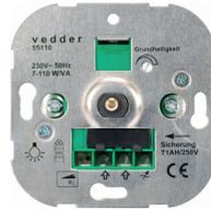
Drehdimmer mit Druck-Wechselschalter, Phasen**an**schnitt, Leistung: 7-110W / VA, LED-Leistung: 3-35W, 230V ~, 50Hz, geeignet für **dimmbare LED-Lampen**, Glühlampen / HV-Halogenlampen und NV-Lampen mit gewickelten Trafos
