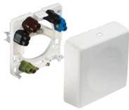
Auf- und Unterputz, bruchgeschützter Deckel mit Schnappverschluss, Nennquerschnitt 2,5 mm<sup>2</sup>, 5 Doppelklemmen, großer Anschlussraum durch kreisförmige Klemmenanordnung, Schraub- und Krallenbefestigung, mit abwerfbaren Spreizkrallen, Dübelbefestigung ist ebenfalls möglich
