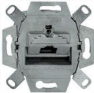
UAE-CAT6A-Anschlussdose, 1x Steckbuchse 8-polig, erfüllt die Anforderungen **für 500 MHz Bandbreite (10Gbit/s)** nach ISO/IEC11801/DIN EN 60603-7-51, anpassbarer Tragrings für Montage in UP-Dosen, Kabelkanälen und UF-Geräteinsätzen
