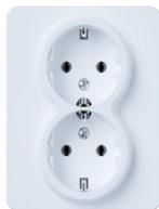
Schuko-Steckdose 2-fach, mit schraubloser Steckklemme, 16A, 250V ~, DIN 49440, Verbindungsklemmen gemäß VDE 0620
