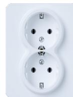
Schuko-Steckdose 2-fach, mit schraubloser Steckklemme, **mit erhöhtem Berührungsschutz (Shutter)**, 16A, 250V ~, DIN 49440, Verbindungsklemmen gemäß VDE 0620
