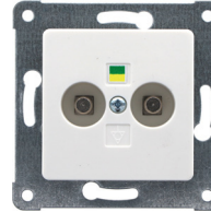
Potentialausgleich-Dose passend in 58er Dose mit Schraubbefestigung, 1-fach, mit Abdeckung, zum Anschluss ortsveränderlicher, medizinischer Geräte Anschlussleitungen bis 1 x 6 mm 2 und 4 x 2,5 mm 2 nach DIN 57197 und VDE 0107 Stecker: Potentialleiter-Winkelstecker nach DIN 42801, bis 6 mm 2
