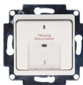
Kontroll-Ausschalter, **2-polig**, 10A, 250V ~, Bedruckung „Heizung Notschalter“, mit Spezialdichtung, inkl. Beleuchtungseinsatz, mit schraublosem Steckanschluss
