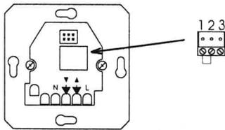
4. Die beiden Adern des Sonnensensors unter dem Tragring oben links durchschieben und durch die Aussparung zur Klemme führen. Die beiden Adern des Sonnensensors auf den Pin 1 und Pin 3 anklammern. Bitte darauf achten, dass die Brücke weiterhin zwischen Pin 1 und Pin 2 bleiben muss.
