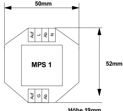
Mehrpunktsteuerrelais für einen Motor
