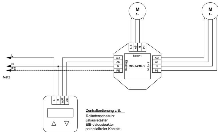
Anschlußbeispiel: Anschluß an eine Rolladenschaltuhr (oder andere Zentralbedienung)
