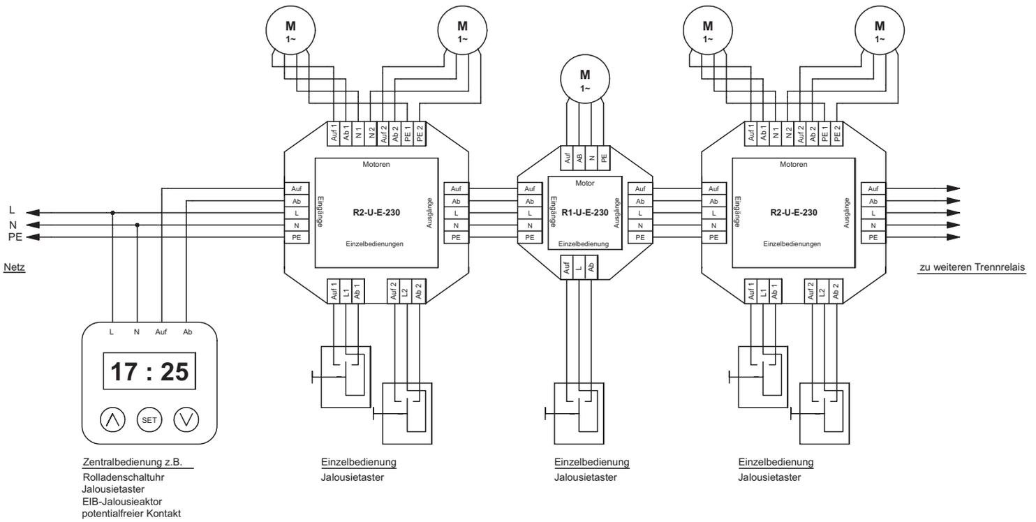
Anschlußbeispiel: Aufbau einer Gruppe mit Zentral- und Einzelbedienung in Kombination mit einem R2-U-E-230
