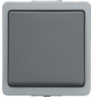
Universalschalter 10 A, 250 V~, Aus-/Wechsel mit schraublosem Steckanschluss IP44
