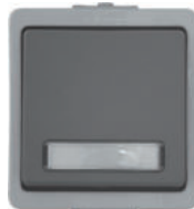
Universalschalter 10 A, 250 V~, Aus-/Wechsel, mit schraublosem Steckanschluss, mit Beschriftungsfeld und Papierstreifen IP44
