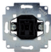
Kontroll-Ausschalter, 2-polig 10 A, 250 V~, inkl. Beleuchtungseinsatz, mit schraublosem Steckanschluss
